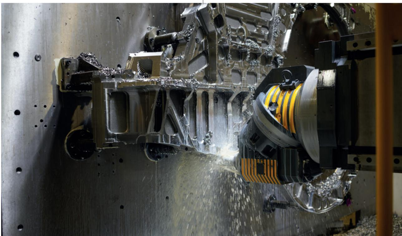
Lavorazione meccanica con macchina a controllo numerico
