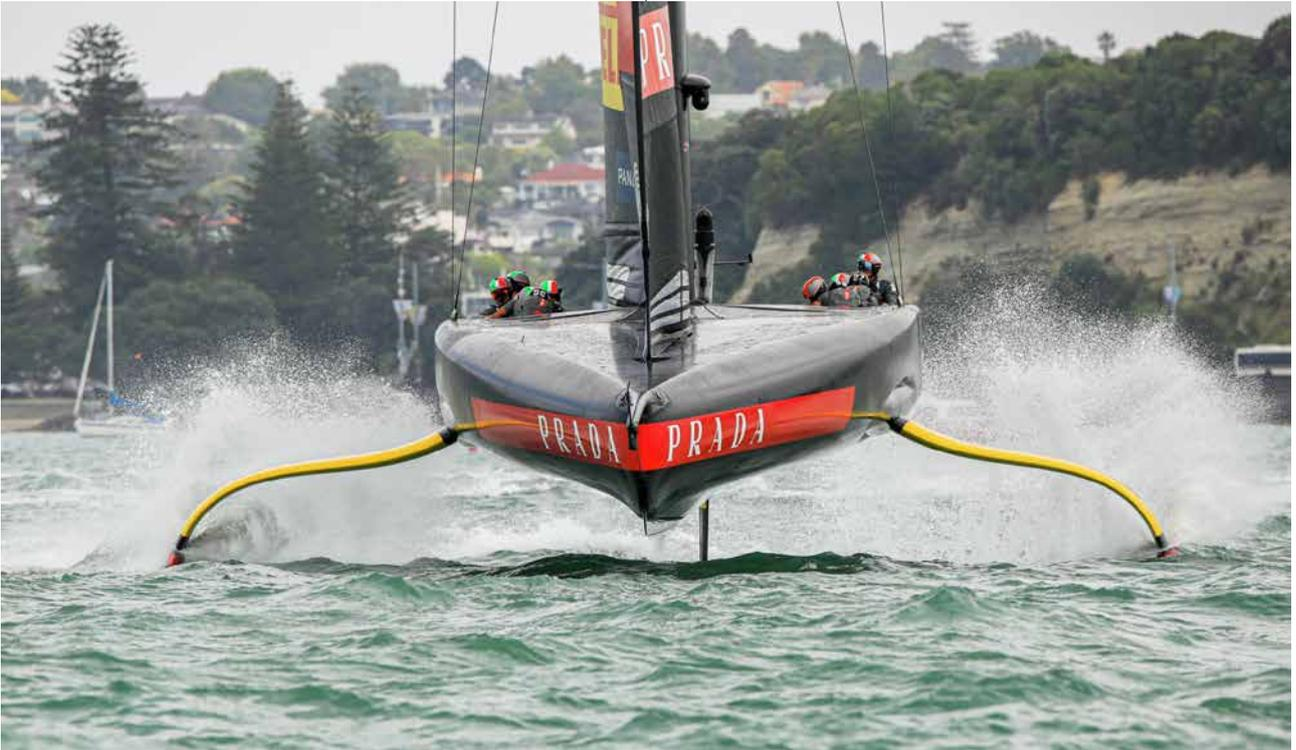
L'AC 75 è un monoscafo di 75 piedi dotato dei cosiddetti “foils”, profili alari basculanti ai due lati della barca che le consentono di planare sull'acqua raggiungendo la velocità di 50 nodi
