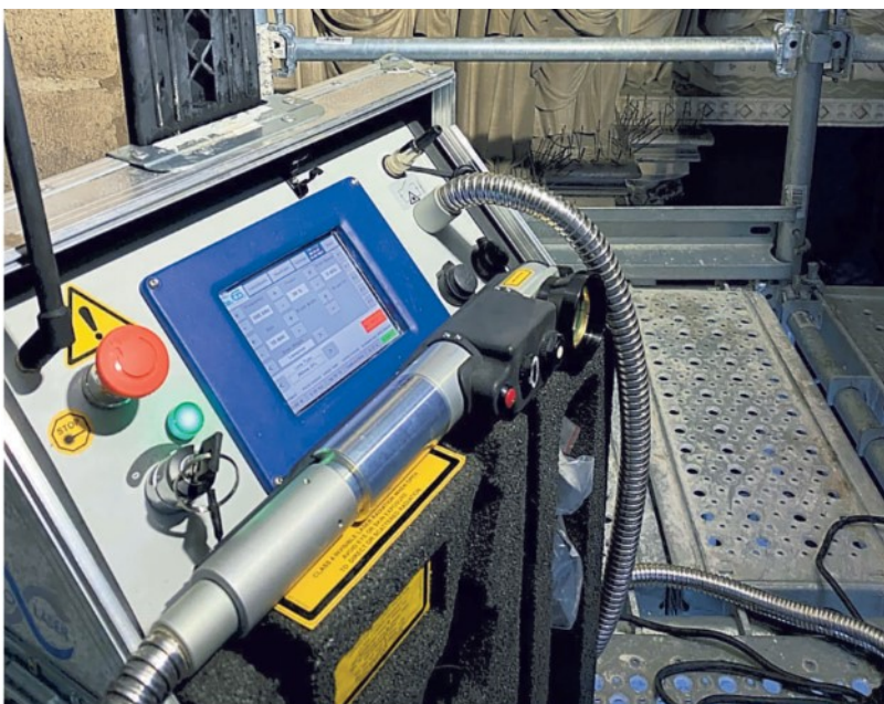
① A Parigi il laser El.En. viene usato per il recupero delle statue annerite di Notre-Dame dopo l'incendio nella cattedrale
