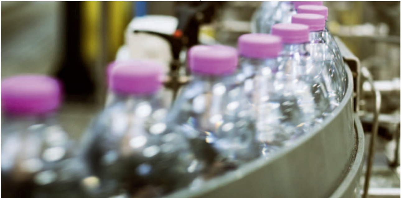
Linea di imbottigliamento di acqua minerale in Pet presso lo stabilimento di Genga (AN)
