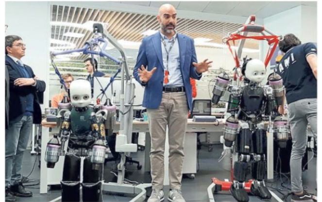
Il robot iRonCub, progettato per volare grazie a gruppi di minireattori
